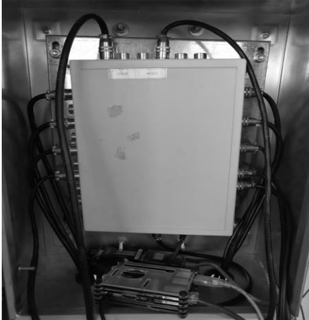
图 3 RPI 与传感器采用通用串行总线连接
